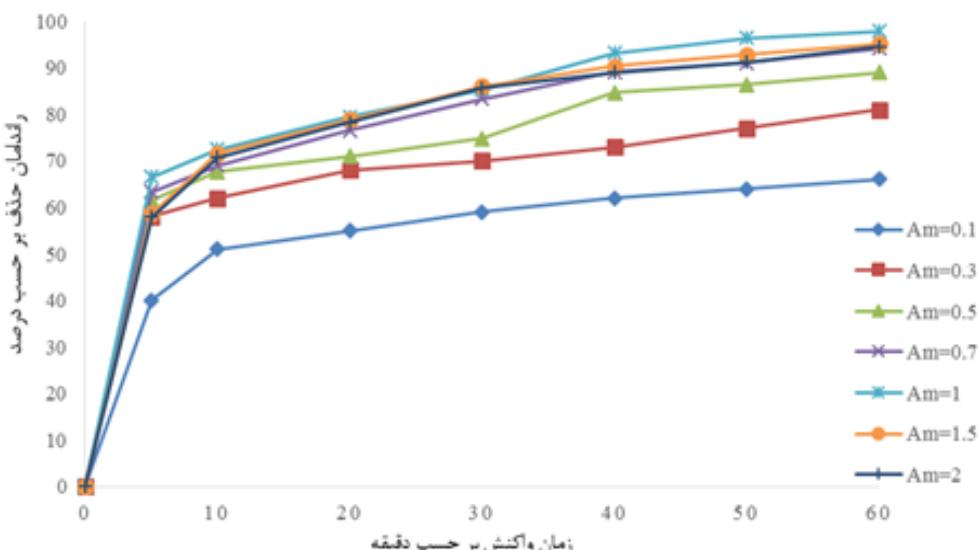
نمودار ۲: بررسی تأثیر تغییرات شدت جریان در میزان حذف اتیدیوم بروماید طی فرایند الکتروشیمیایی (غلظت اتیدیوم بروماید  $50 \text{ mg/L}$ ، پرسولفات سدیم  $0.5 \text{ g/L}$ ،  $\text{pH}=4$ )
