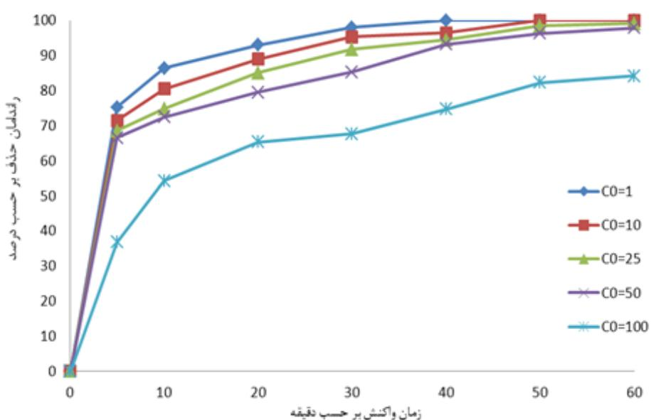
نمودار ۴: بررسی تغییرات غلظت اولیه اتیدیوم بروماید در فرایند الکتروشیمیایی (پرسولفات سدیم  $5 \text{ g/L}$ ، جریان الکتریکی  $1 \text{ mA/cm}^2$ ،  $\text{pH}=4$ ، سولفات سدیم  $0.5 \text{ g/L}$ )
