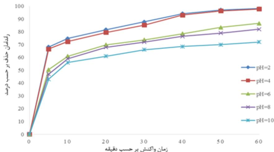
نمودار ۱: بررسی تأثیر تغییرات pH محیط در میزان حذف اتیدیوم بروماید طی فرایند الکتروشیمیایی (غلظت اتیدیوم بروماید  $50\text{ mg/L}$ ، پرسولفات سدیم  $0/5\text{ g/L}$ ، جریان الکتریکی  $1\text{ mA/cm}^2$ ، زمان واکنش  $60\text{ min}$ )
