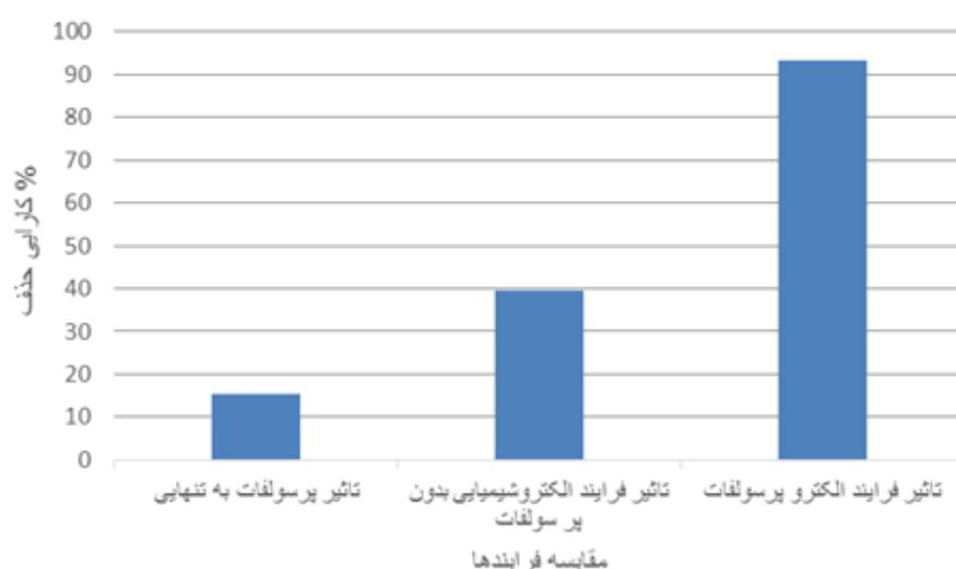
نمودار ۵: بررسی تاثیر مجازی پرسولفات، الکتروشیمیایی بدون پرسولفات و فرایند الکتروپرسولفات در حذف اتیدیوم بروماید (غلظت اتیدیوم بروماید  $50 \text{ mg/L}$ ، پرسولفات سدیم  $5 \text{ g/L}$ ، جریان الکتریکی  $1 \text{ mA/cm}^2$ ، سولفات سدیم  $0.5 \text{ g/L}$ ،  $\text{pH}=4$ )
