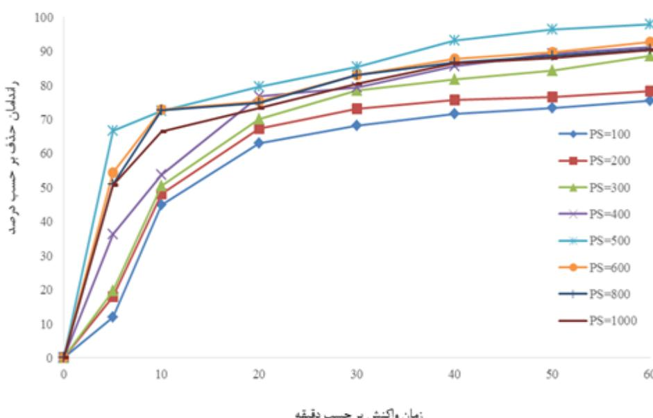
نمودار ۳: بررسی تأثیر تغییرات PS در میزان حذف اتیدیوم بروماید طی فرایند الکتروشیمیایی (غلظت اتیدیوم بروماید  $50 \text{ mg/L}$ ، سولفات سدیم  $0.5 \text{ g/L}$ ،  $\text{pH}=4$ )
